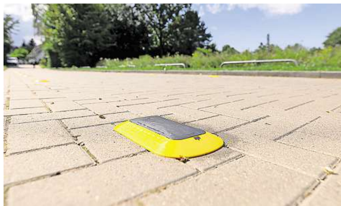
Solche Sensoren – wie hier im Drägerpark – dienen in Lübeck derzeit nur dazu, Falschparker zu melden. Doch sie könnten auch helfen, freie Parkplätze zu finden.
