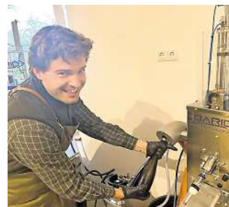
Mitgründer der „Holsteiner Degorgier“ Georg Grimm befördert die gefrorene Hefe aus dem Flaschenhals.
