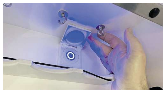
Viele der Rettungswagen in Ostholstein wurden in den vergangenen Monaten mit kleinen Antennen auf dem Dach, einem Router sowie einem Reset-Knopf für eben diesen ausgestattet.
