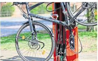
Diebstahlgesichert: Die Werkzeuge sind mit Drahtseilen an den Stationen befestigt.
