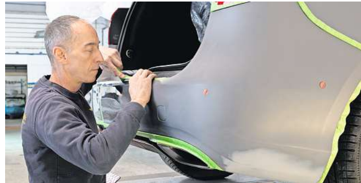
Vorbereitung: Das gespachtelte Bauteil am Fahrzeug wird von Lackierermeister Nico Wiczorek fachgerecht abgeklebt. Foto: Hötzsch
