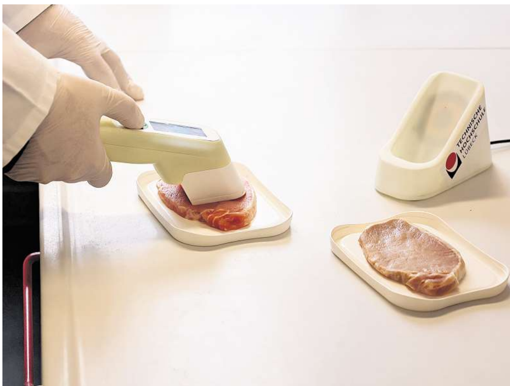
So sieht der aktuelle Prototyp des Frische-Sensors aus, der aktuell im TH-Labor getestet wird. Fotos: THL
