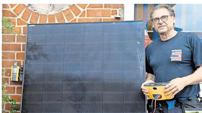
Mit dem neuen Messgerät kann Tim Stasch, Inhaber der Firma Elektro Stasch, die neu installierte Photovoltaikanlage überprüfen und die Ergebnisse dokumentieren.
