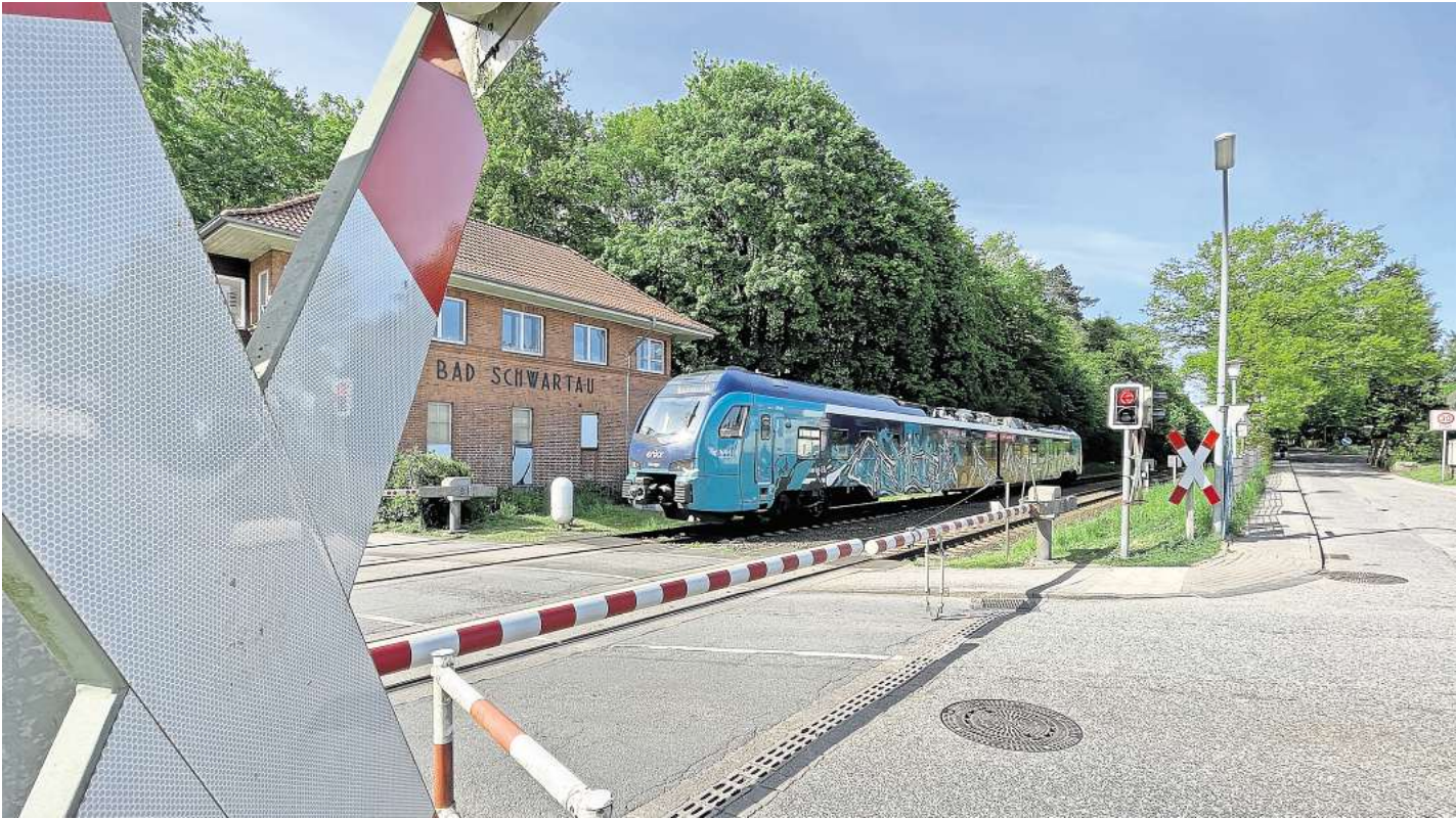
Der Bahnübergang Kaltenhöfer Straße in Bad Schwartau entfällt für die Belttunnel-Hinterlandanbindung, die Gleise sollen durch einen Trog geführt werden. Dafür wird eine Brücke zur Geibelstraße gebaut. Foto: Manuel Büchner
