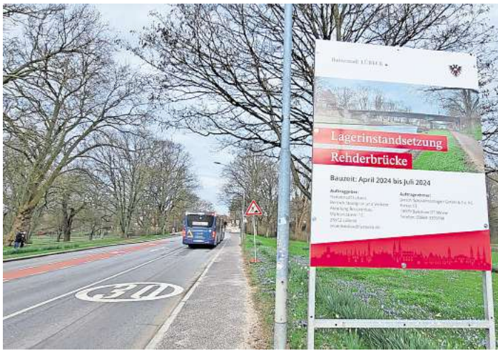
Die Rehderbrücke muss angehoben werden, damit neue Lager eingebaut werden können. Foto: Holger Kröger
