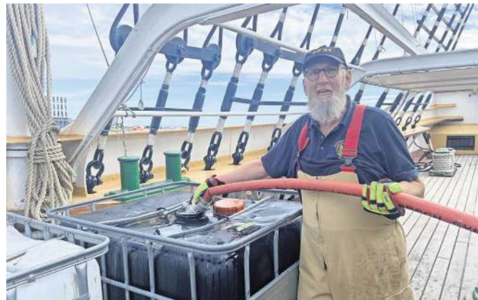
Michael Beier von der Freiwilligen Feuerwehr Lübeck-Priwall befüllt an Deck einen Wassertank für den Krängungstest.
