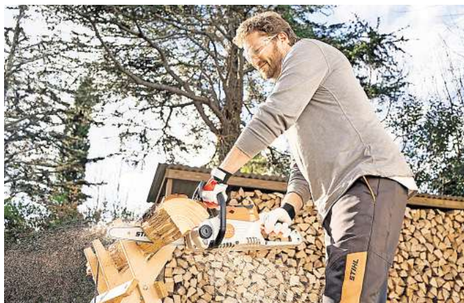
Akkubetriebene Motorsägen eignen sich dazu, das Holz vor dem Einlagern und Trocknen in kamingerechte Abschnitte zu sägen.
