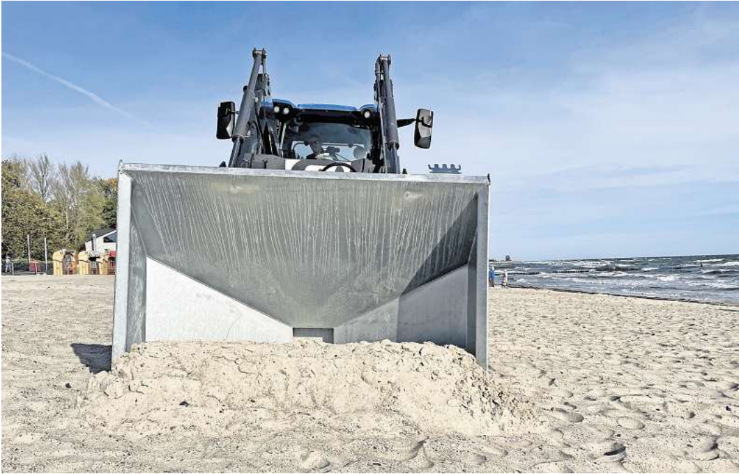
Mit dem Bagger wird Sand in den Big-Pack-Füller geschoben.
