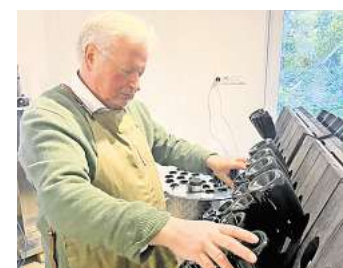
Friedrich Christian Grimm dreht jede einzelne Flasche, die kopfüber in den Rüttelplatten stecken, in einem bestimmten Winkel – und das 21 Tage lang.
