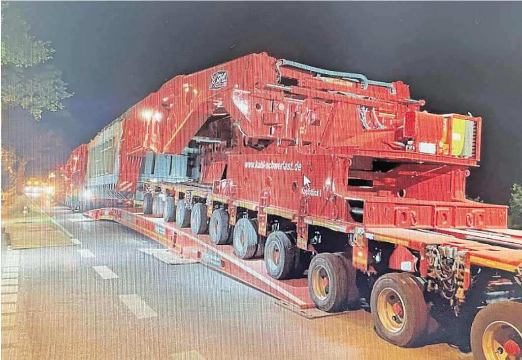
So eine mobile Spezialbrücke wird über die Brücke in der Kaltenhöfer Straße in Bad Schwartau errichtet. Sie macht den Transport der schweren Transformatoren über die Schwartau erst möglich. Foto: Karl & Jansen GmbH, hfr
