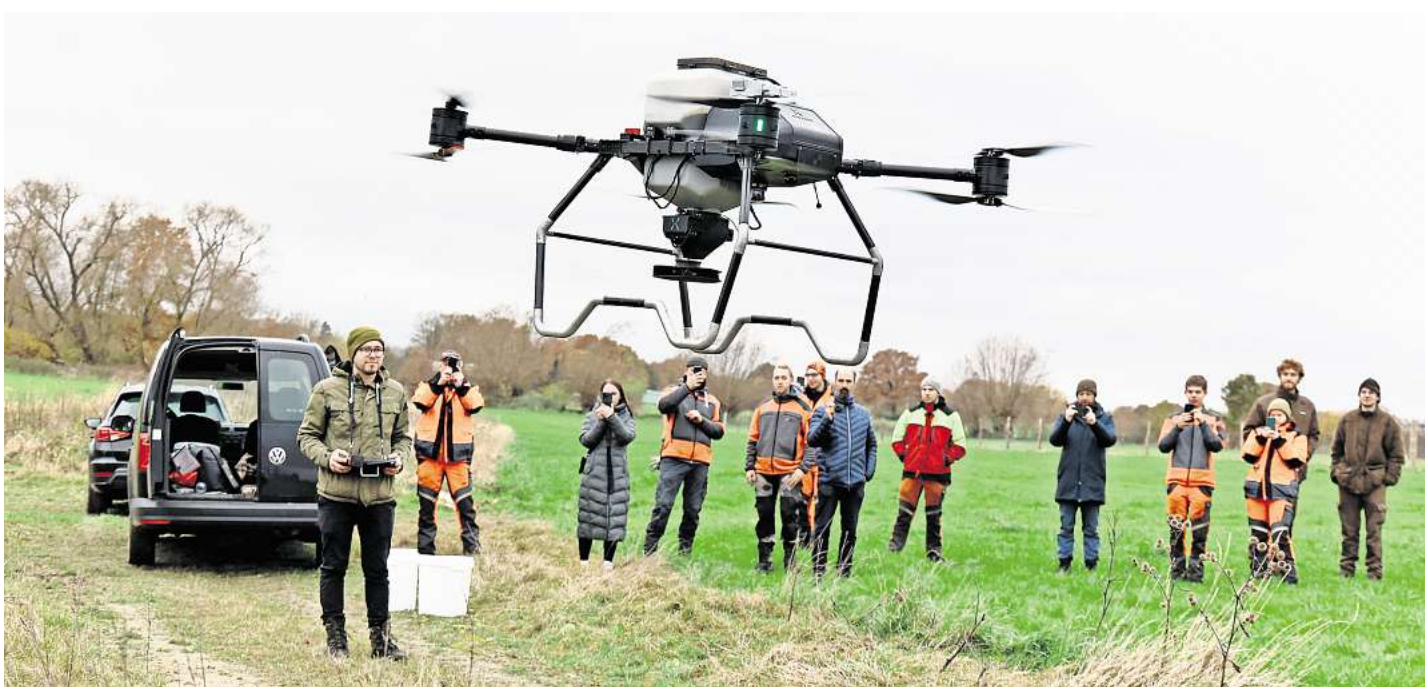
„Thor“ hebt ab, um verschiedene Baumarten auszusäen: Pilot Raphael Müller (l.) steuert nicht nur die Drohne, sondern hat auch den Aus-saatmechanismus konstruiert.
