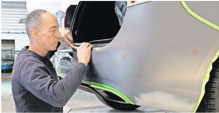
Vorbereitung: Das gespachtelte Bauteil am Fahrzeug wird von Lackierermeister Nico Wiczorek fachgerecht abgeklebt. Foto: Hötzsch
